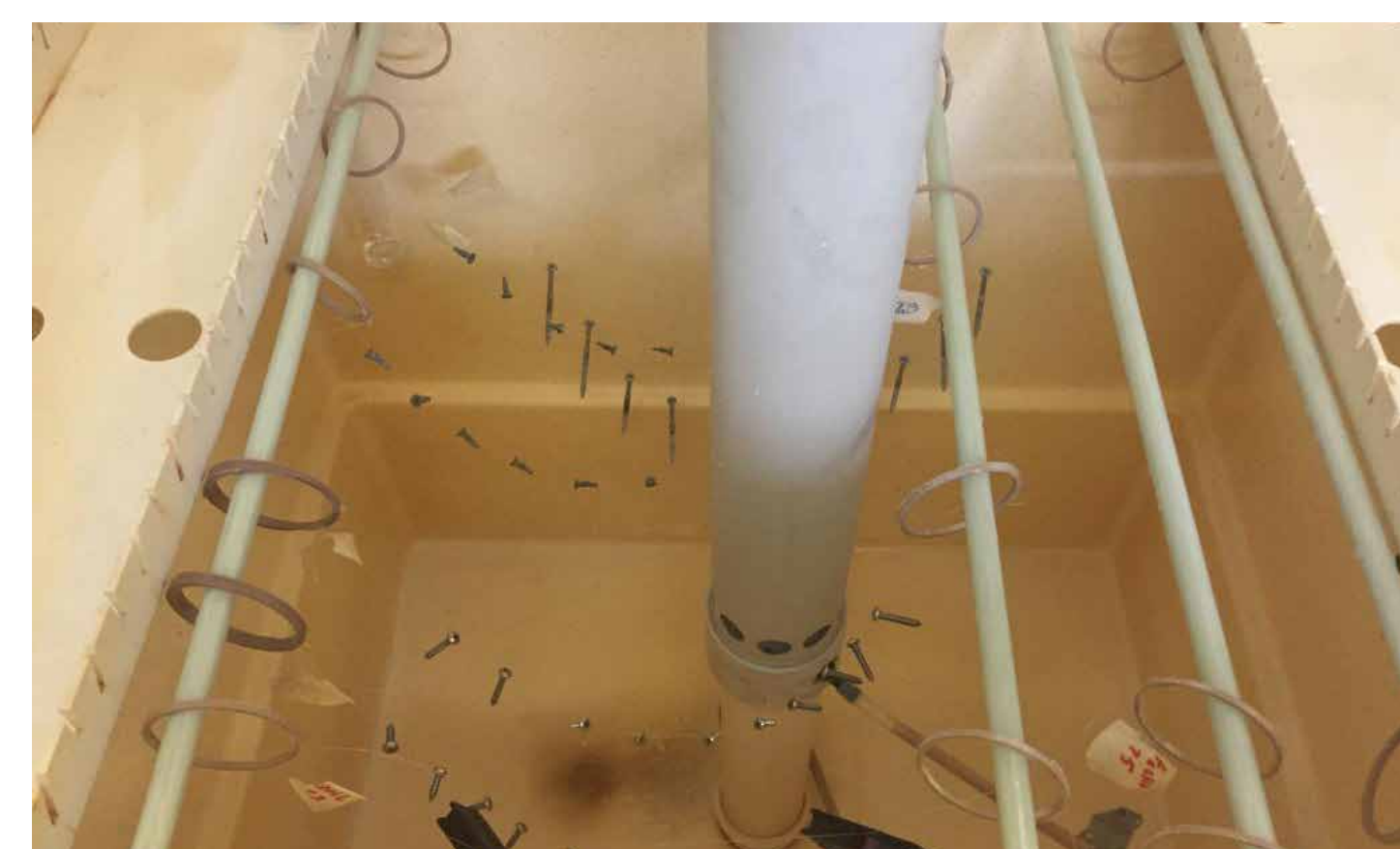
Avaliação da resistência à corrosão dos componentes metálicos por meio de ensaio de salt-spray de acordo com a NBR 8094.
