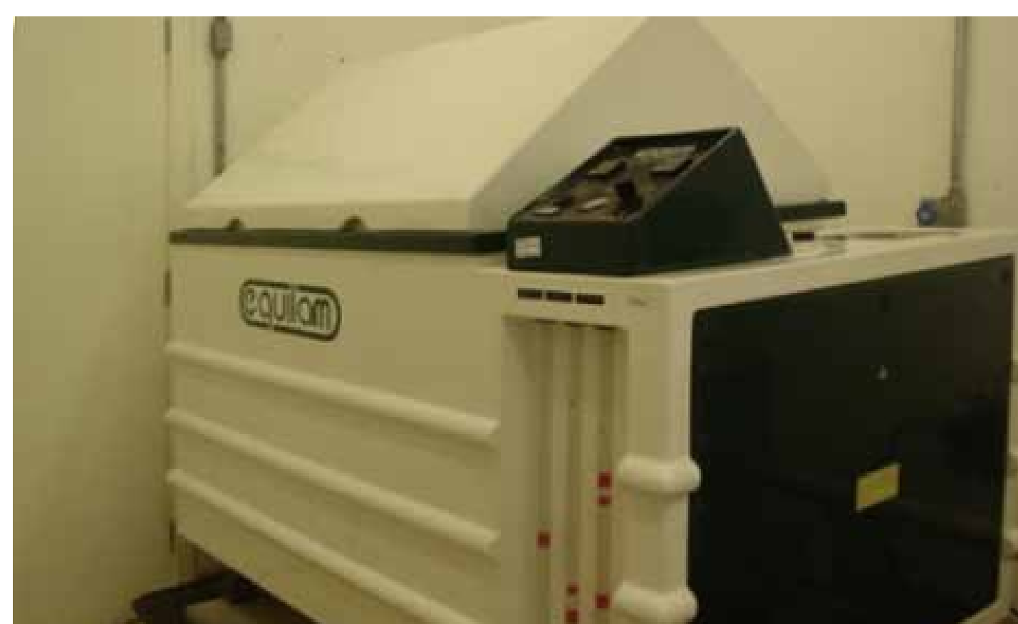
Avaliação da resistência à corrosão dos componentes metálicos por meio de ensaio de salt-spray de acordo com a NBR 8094.
