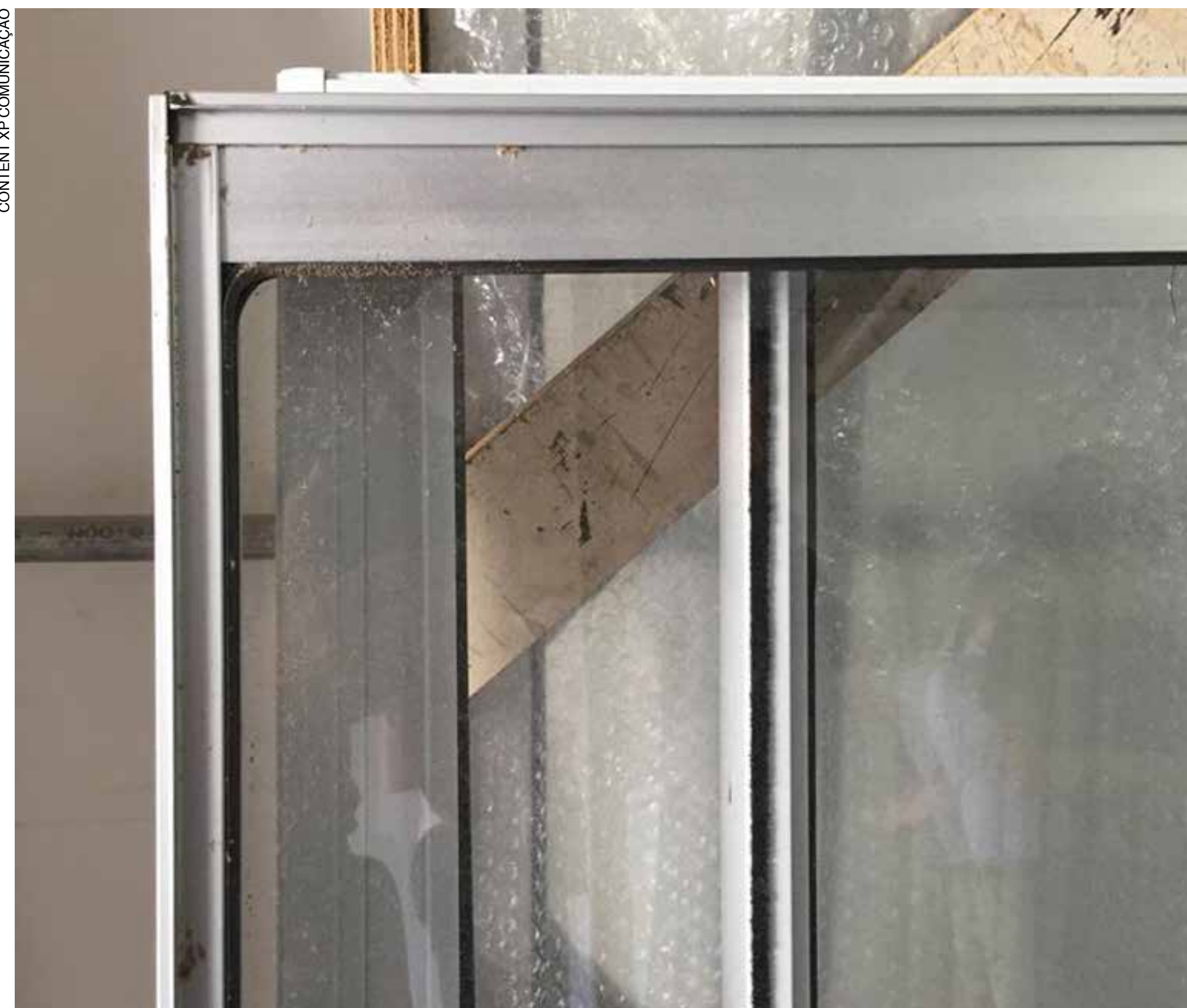
Esquadria de alumínio de correr, 1200 x 1500 mm, duas folhas, durante realização de teste de estaqueidade na Tesis.
