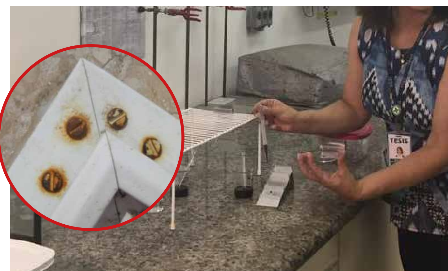
Análise de corrosão em perfis e em parafusos (detalhe na lupa), comprometendo o desempenho mecânico e a estética do equipamento.
