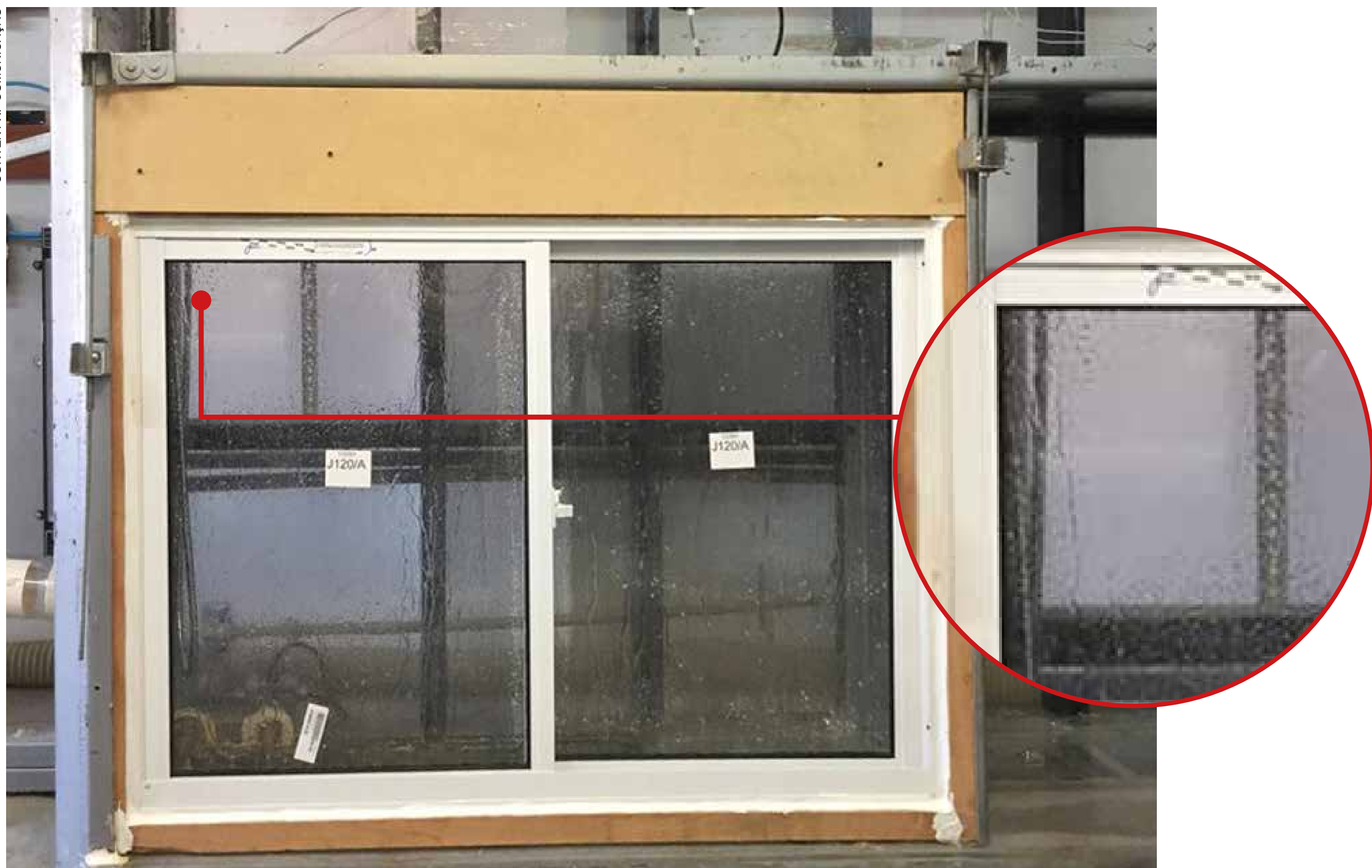
Ensaio de determinação de estanqueidade de caixilho de alumínio de duas folhas realizado na Tesis, em São Paulo. Simulação sucessiva de condições naturais, intempéries.
