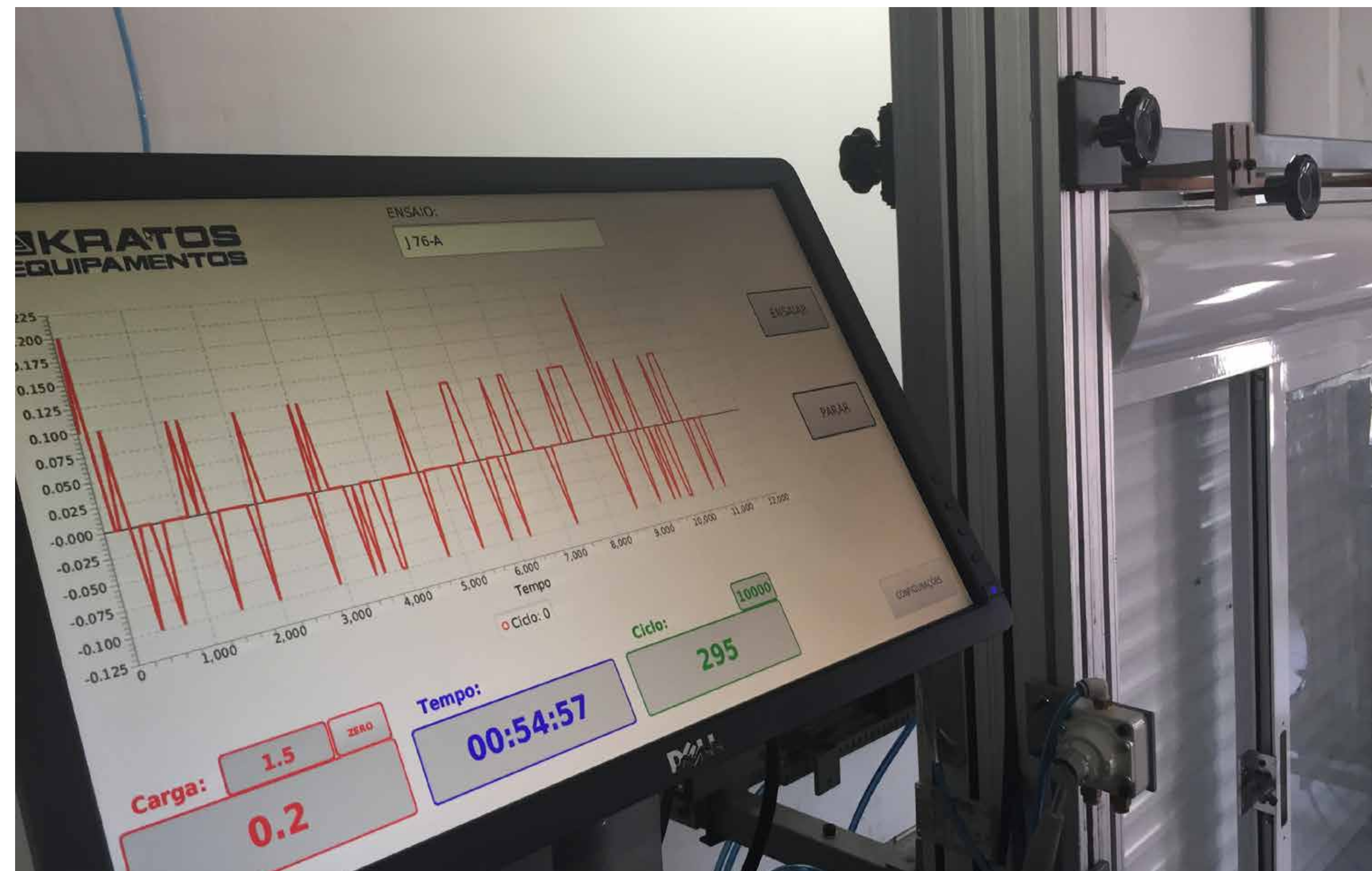
Abertura e fechamento sucessivos de persiana acoplada ao caixilho de alumínio durante testes de resistência mecânica realizados pela Tesis, em São Paulo.
