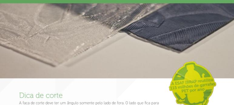
A faca de corte deve ter um ângulo somente pelo lado de fora. O lado que fica para dentro deve ser reto para evitar formação de rebarba, possibilitando um corte sem trincas e facilitando a produção.
